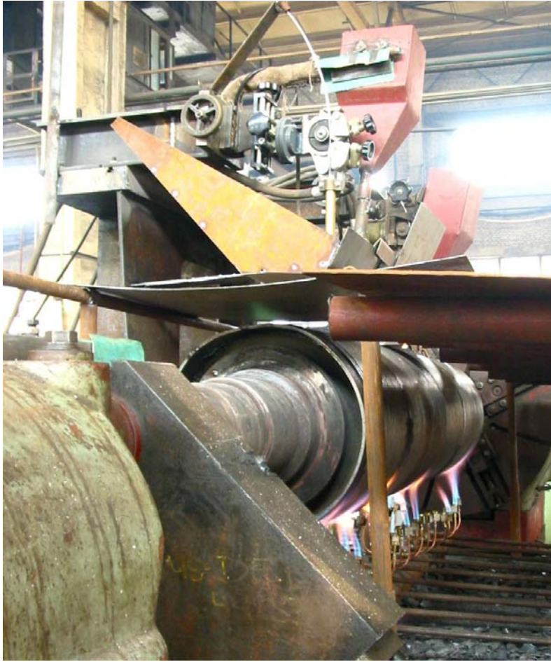
加热烧嘴在首钢迁钢生产现场
